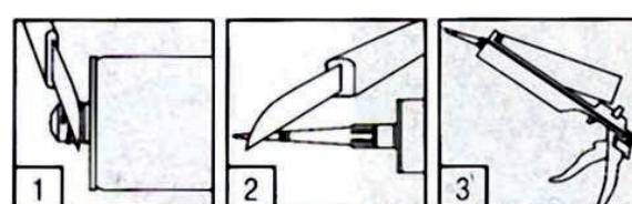
Naneste lepidlo na jeden z povrchov: vo forme bodu pre vyhladenie nerovnomerných povrchov (1); vo forme vlnky pre výšiu počiatocnú pevnosť na širšie povrhy (2); alebo ako rovné pásy na menšie povrhy (3). V prípade vonkajšieho použitia naneste vertikálne pásy.
